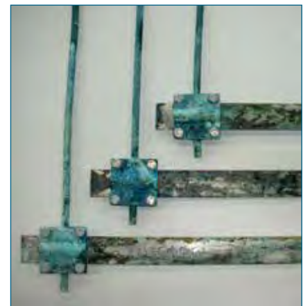
Résultat de test de vieillissement en brouillard salin
