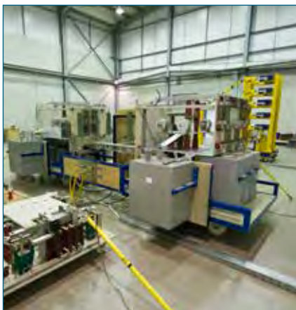
Générateur d'impulsion de courant 100kA, 10/350µsec (1)
